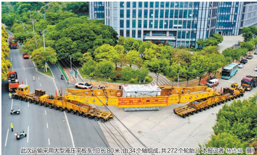
此次运输采用大型液压平板车，总长80米，由34个轴组成，共272个轮胎。(本报记者 杨建福 摄)
